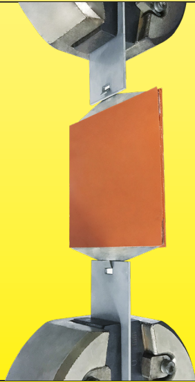
Equipo de prueba de fuerza de desgarro
